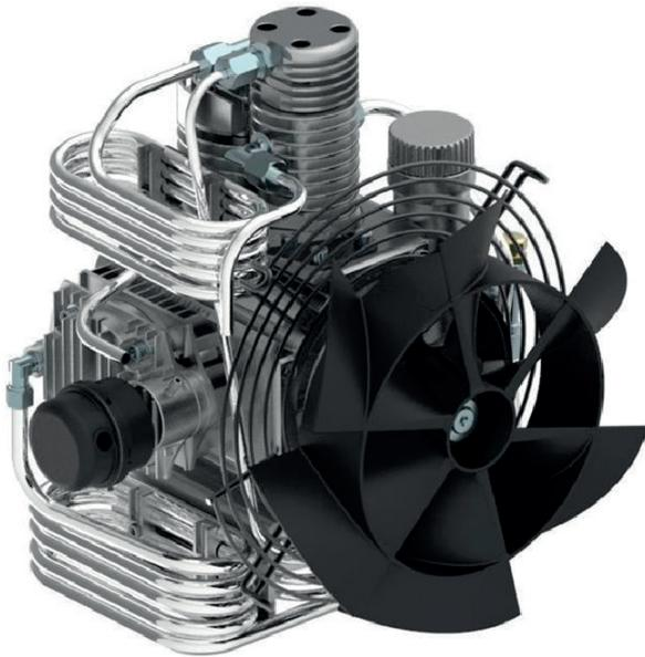
Los cojinetes del cigüeñal son todos europeos que garantizan una larga vida útil del compresor. El enfriamiento del aire comprimido se realiza a través de los serpentines de enfriamiento inter-etapas de aluminio y acero inoxidable. Se trata de un compresor pequeño con 4 etapas de compresión y todos los anillos de pistón están hechos de hierro fundido que proporciona un alto rendimiento en el tiempo.
